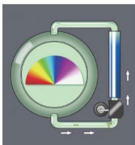
SPECTROBLUE的卓越性能令人惊憾。它还配备了斯派克公司的UV-PLUS气体净化系统。在密闭充氦的光学室内，用小型隔膜泵使氦气通过净化管净化循环，确保系统的长期稳定性和100%的利用率，它无需任何额外的高纯气体消耗。
