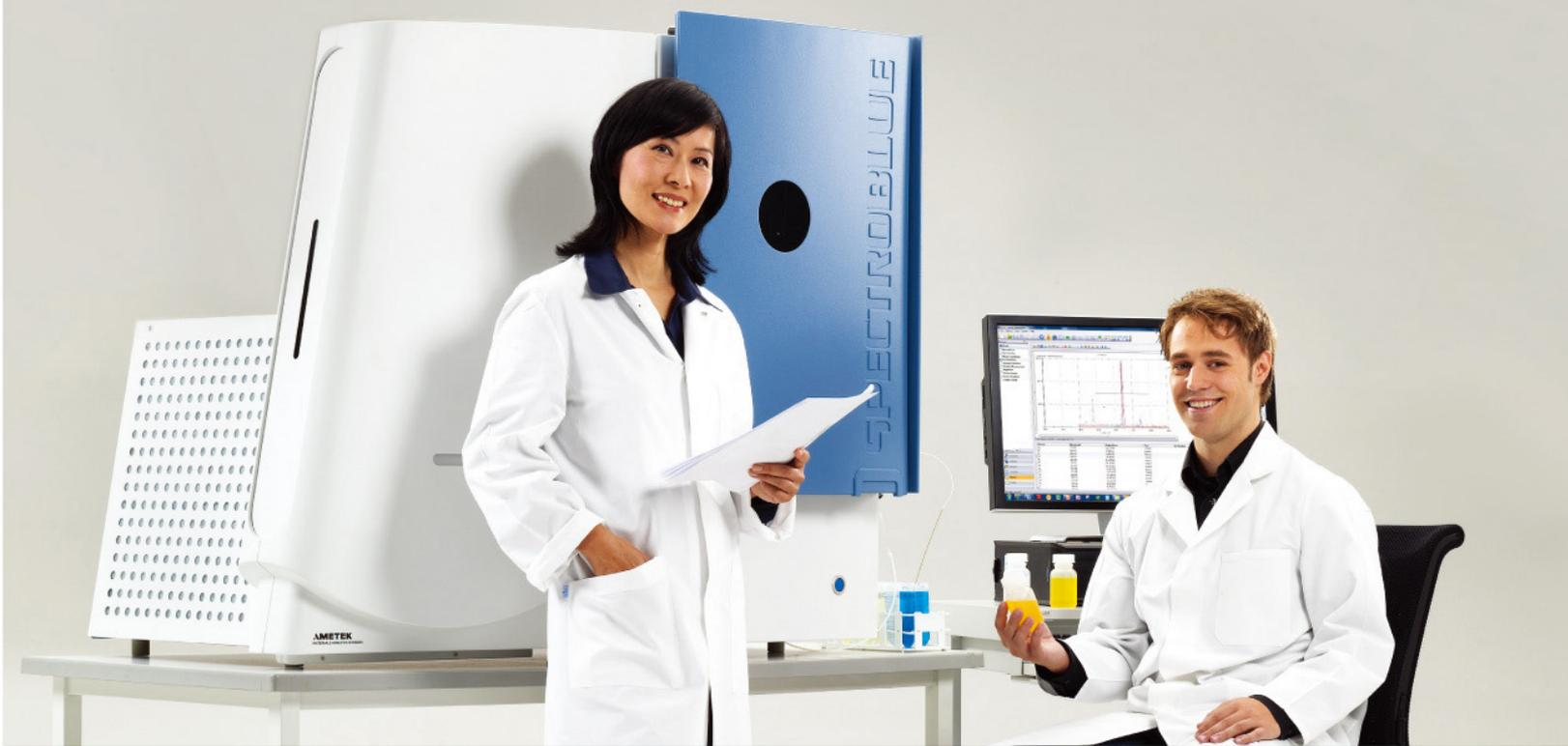
斯派克公司为**SPECTROBLUE**精心设计了完美地控制分析成本的软硬件。其同时全谱直读的分析能力，使样品分析速度快、成本低、高样品量运行，这是其它时序测量仪器所无法比拟的。同时，其样品溶液输送路径最短化以及其它的创新设计，缩短了进样时间与换样的冲洗时间，降低记忆效应，从而节省时间和成本，甚至也好于其它的同时全谱直读仪器。**SPECTROBLUE**的光学系统采用高紫外传输效率的**UV - PLUS**装置，使其十分稳定、无需维护；同时，这种新颖的密封系统也不再需要耗费高纯气体，使仪器在使用寿命期内所节省的费用可达其购买费用的三分之一。**SPECTROBLUE**拥有的独一无二的**OPI - AIR**光学等离子体接口，使其成为首台无需购买外冷设备并为其消耗能源的**ICP - OES**仪器。
