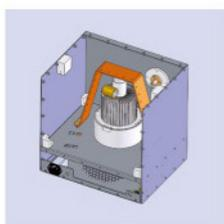
RF发生器的先进设计，使其可靠性与效率达到最大化，即使是极端的等离子体负载也能提供足够的输出功率。此外，27MHz自激振荡器提供较宽的频率带宽，无论负荷如何，输出功率都能有效而稳定地输送到等离子体中。
